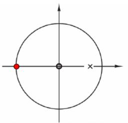
$$H_2(z) = \frac{1 - \alpha}{2} \frac{(1 + z^{-1})}{(1 - \alpha z^{-1})} = \frac{1 - \alpha}{2} \frac{(z + 1)}{(z - \alpha)}$$
