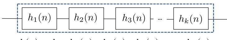
$$h(n) = h_0 \cdot h_1(n) * h_2(n) * h_3(n) * \dots * h_k(n)$$
